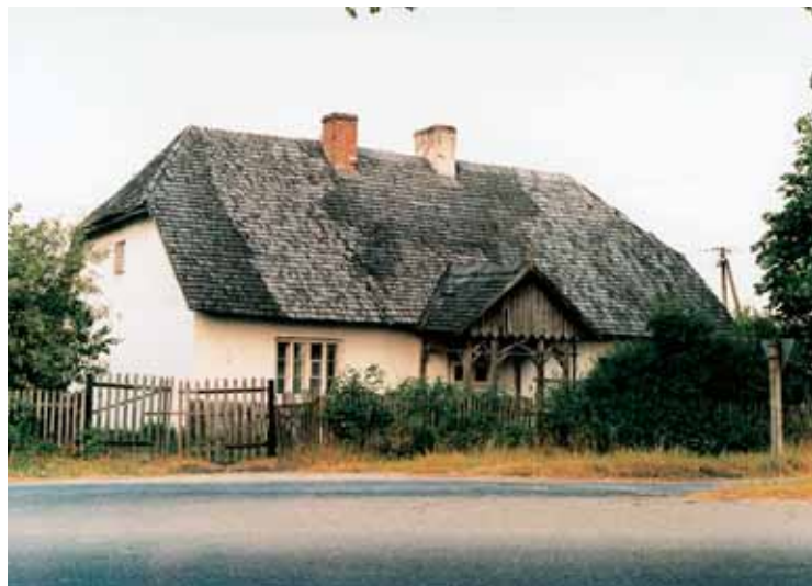
Dach naczółkowy kryty gontem, Szczepieszyn-Roztocze (woj. lubelskie)
